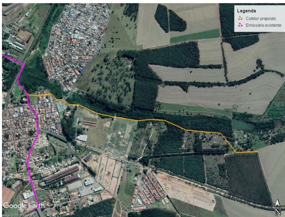
Figura 5. Caminhamento do coletor proposto.
